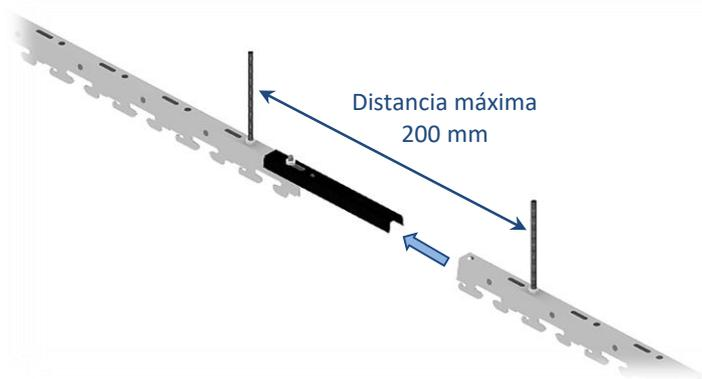
Si es necesario unir las lamas G, es fundamental tener en cuenta la aplicación de perfiles de suspensión en ambos lados de la unión, con una distancia máxima de 200 mm entre ejes.
