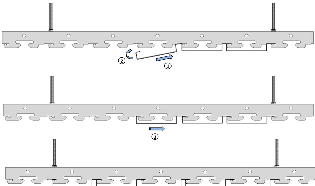
7. Si es necesario unir las lamas G, debe introducir las piezas de unión dentro de las lamas, por encima de ellas y doblar los extremos de las piezas sobre las lamas a unir, como se muestra en las siguientes figuras.
