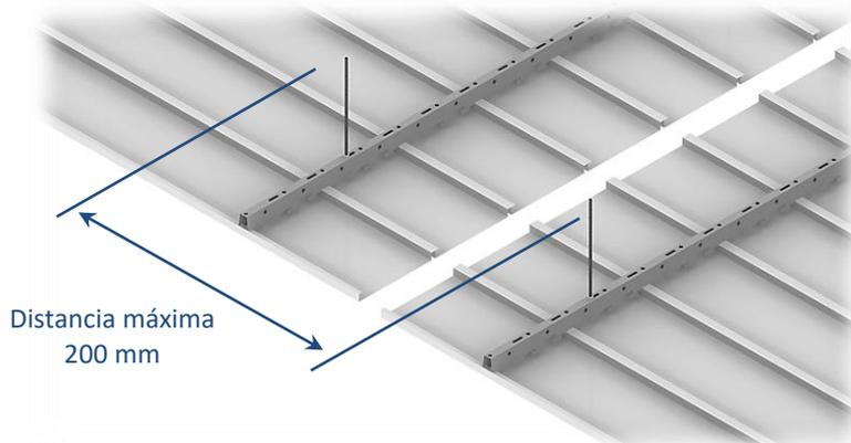
5. Comprobar que la estructura esté completamente nivelada.
