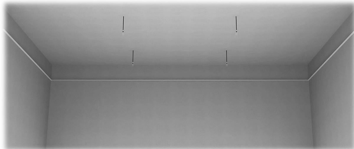
4. Aplicar los perfiles de suspensión primarios Eurobex de 3700mm, deslizándolos en las respectivas piezas de suspensión OSRV.
