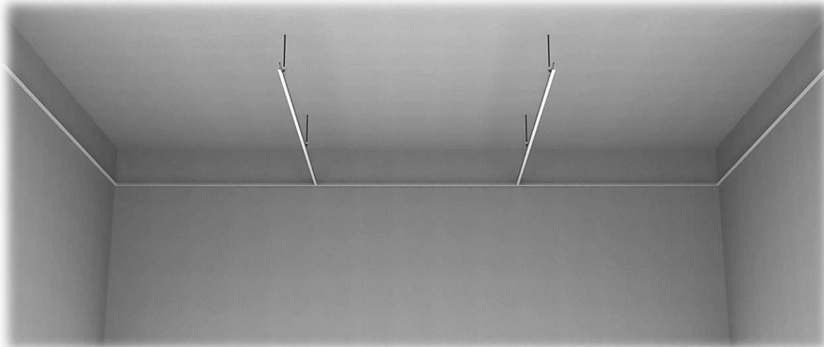
5. Inserir los perfiles de suspensión secundarios Eurobex de 1200mm, con su acoplamiento a los perfiles primarios de 3700mm. **La distancia entre los perfiles secundarios Eurobex de 1200mm debe ser de 600mm.**
